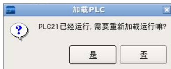
图 4-2-6-2 加载 PLC 对话框-重新下载并运行
