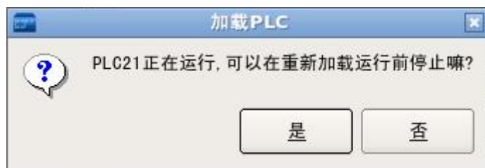
图 4-2-6-3 加载 PLC 对话框-加载前停止运行
