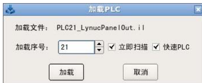
图 4-2-6-1 加载 PLC 对话框
