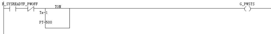
图 5-5-1-1 指定编号延时导通计时器指令梯形图
