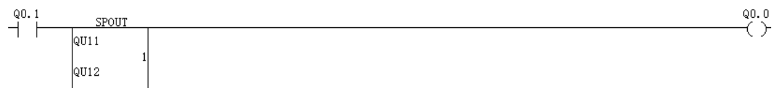
图 11-3-2-1 主轴输出 SPOUT 指令梯形图
