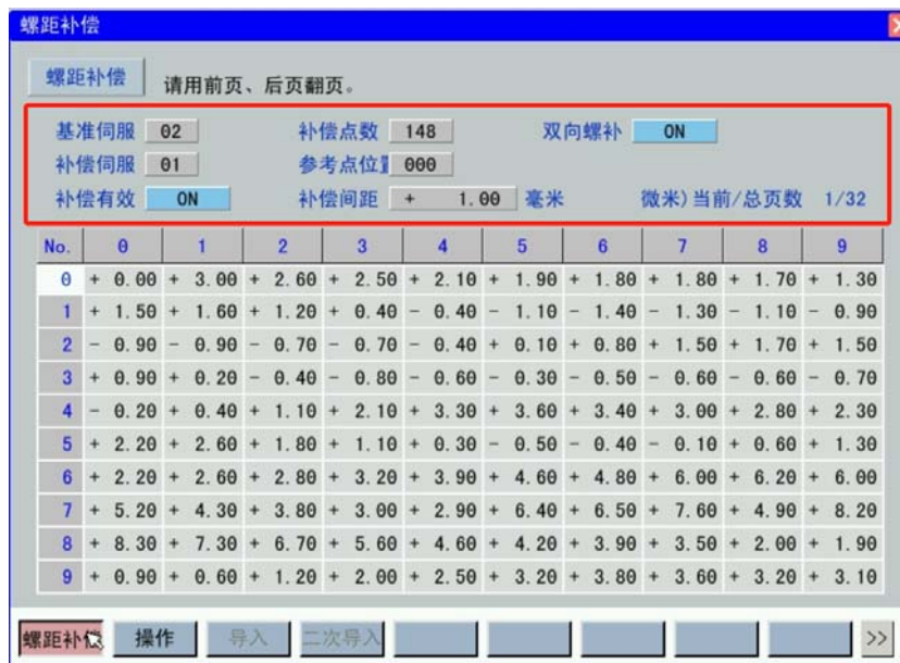
图 7-8 螺距补偿参数设置
