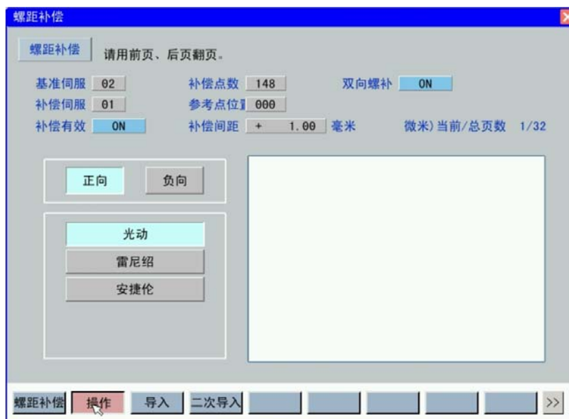
图 7-9 螺距补偿二次导入
