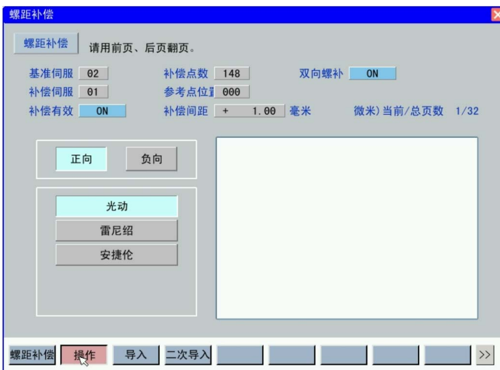
图 7-9 螺距补偿二次导入
