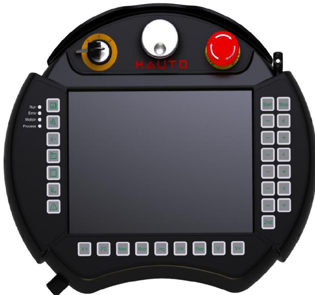
图 2-1 示教器操作面板
