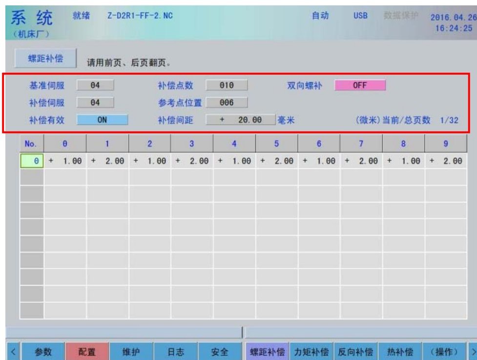
图 11-12 螺距补偿参数设置
