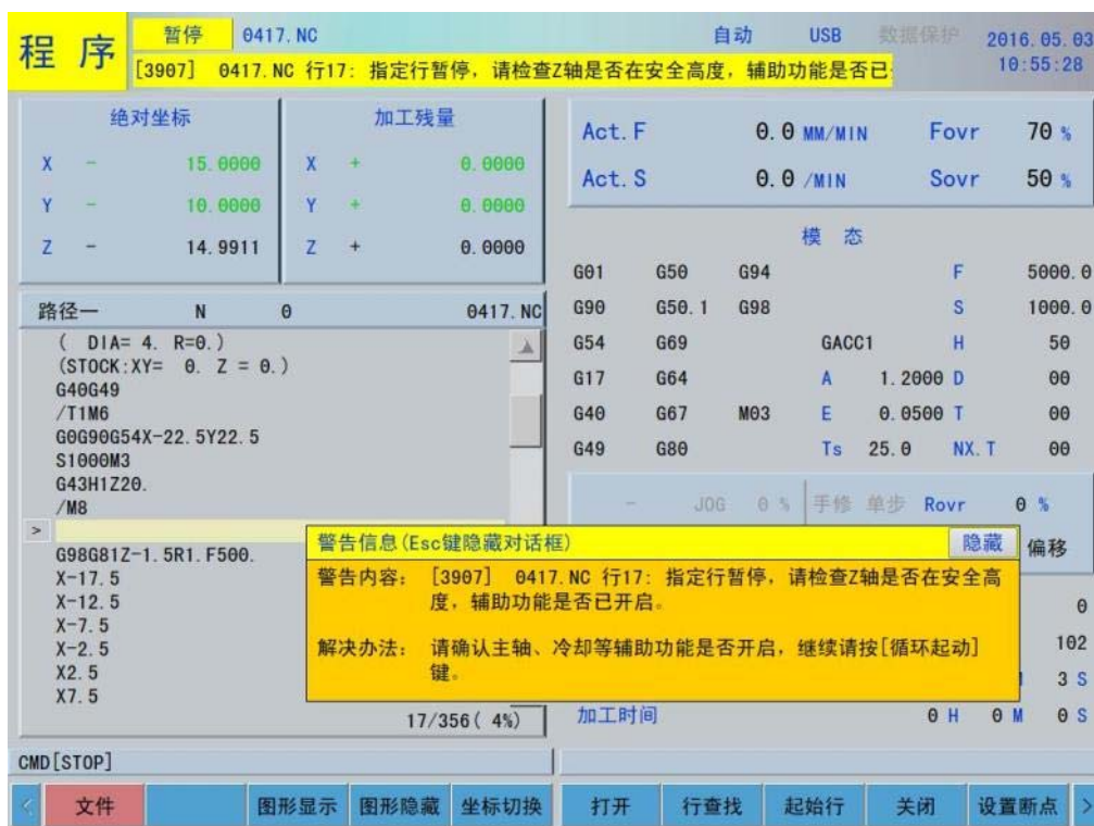
图 6-7 指定起始行-确认 Z 轴安全高度
