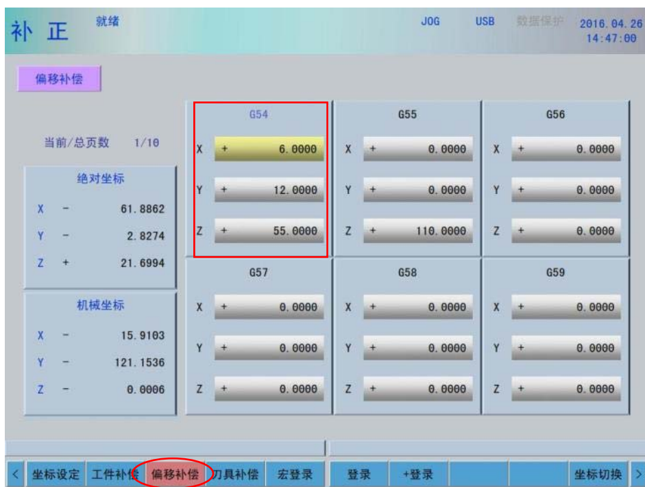
图 5-6 【启用外部坐标系补偿】参数 Off
