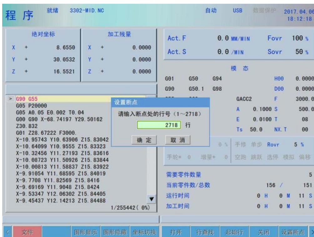
图 6-11 断点行号输入界面
