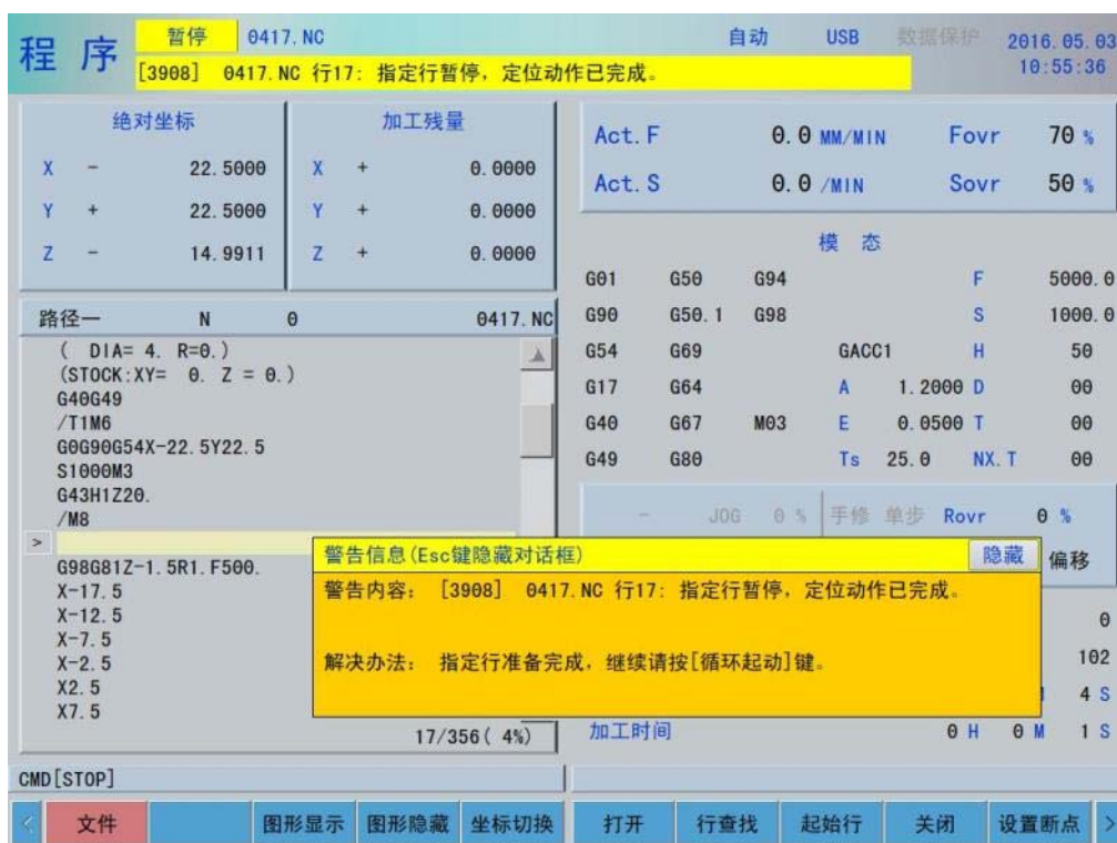
图 6-8 指定起始行-定位动作完成
