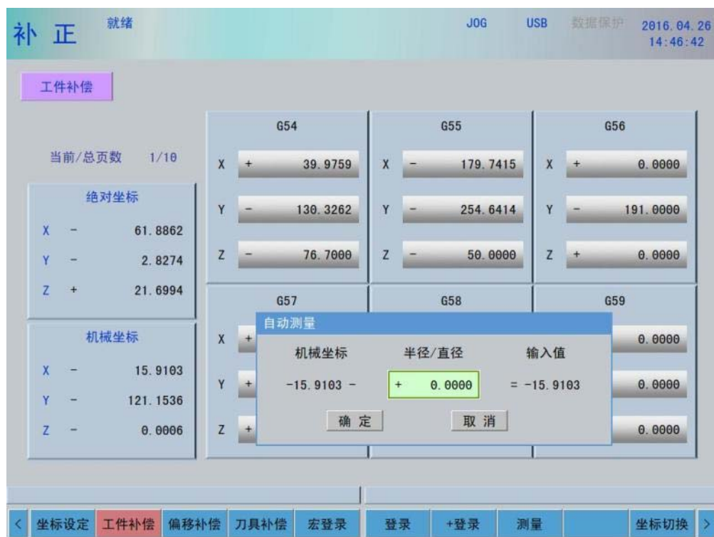
图 5-4 工件补偿自动测量
