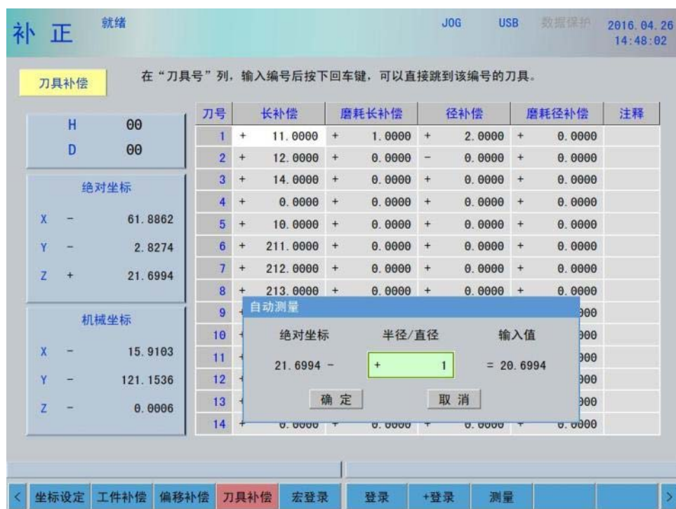
图 5-8 刀具补偿-自动测量
