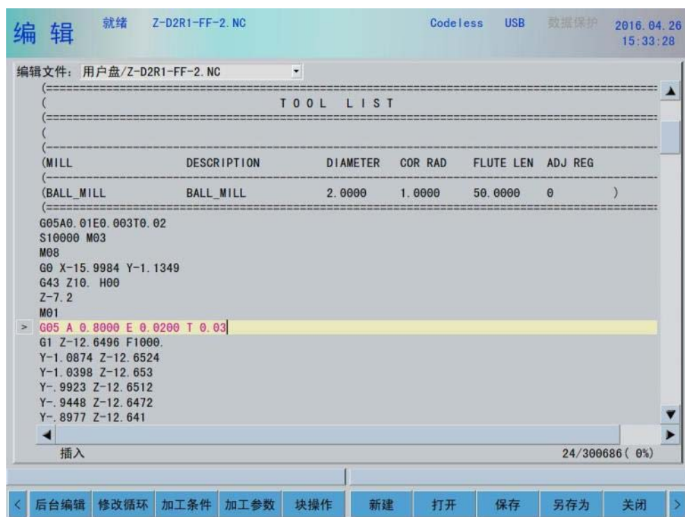
图 9-15 加工参数的确认
