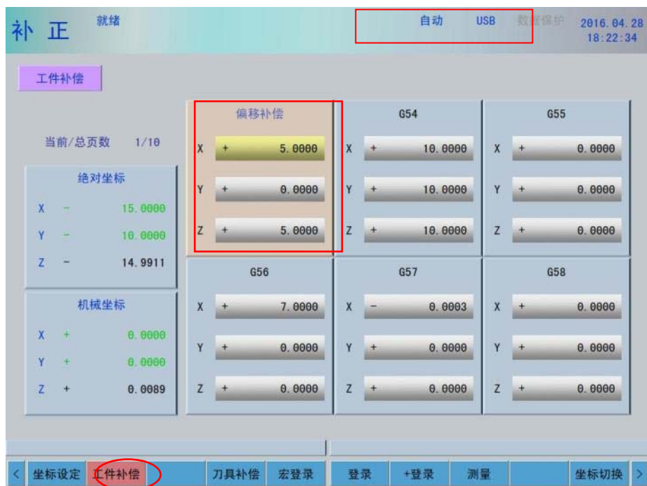
图 5-5 【启用外部坐标系补偿】参数 ON
