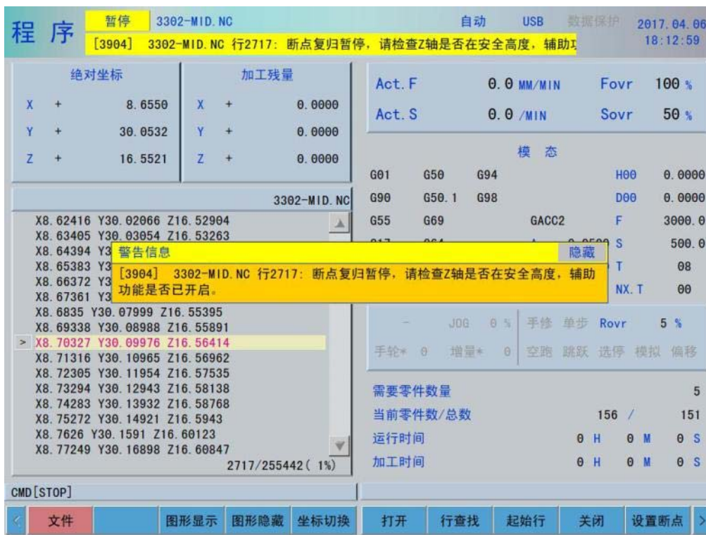
图 6-14 检查 Z 轴是否处于安全高度
