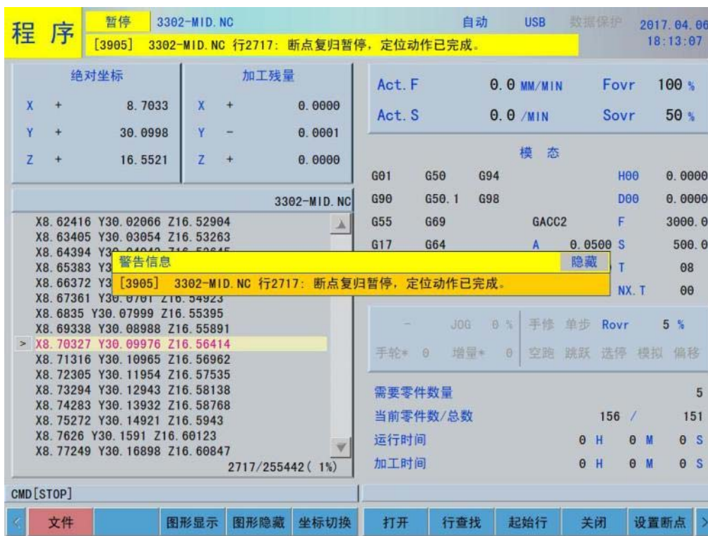
图 6-15 断点复归定位完成
