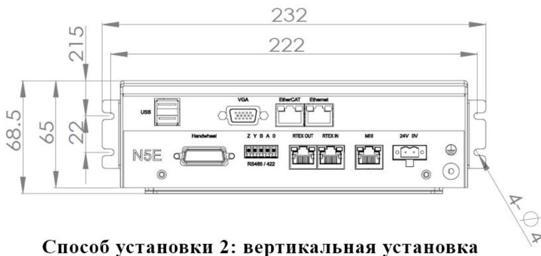
Рисунок 4- 1 Размеры монтажных отверстий моноблочного контроллера N5E
