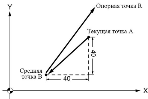
Рис.5-6 Значение координат промежуточной точки при модуле инкрементной команды
