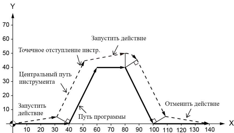
Рис. 9-11 Автоматический возврат неподвижной команды
