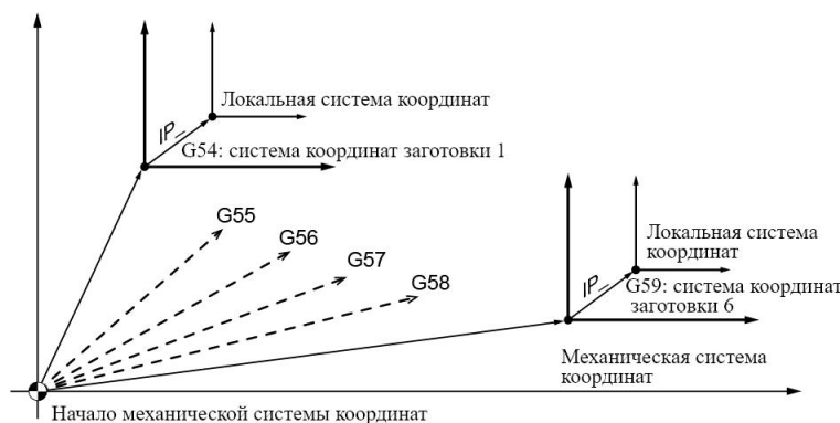
Рис. 6-1 Отношение между системами координат станка
