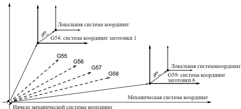
Рисунок 6-7 Отношение локальной системы координат к системе координат заготовки
