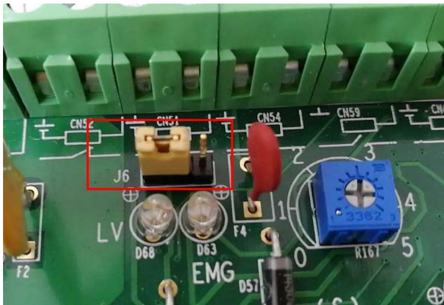
图 3-21 上电跳线示意图
