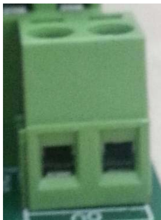
图 3-32 抱闸线圈端子
