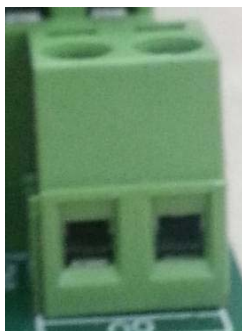
图 3-30 伺服强电常开辅助触点端子
