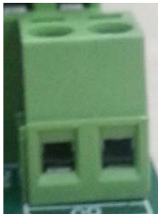
图 3-23 急停开关端子
